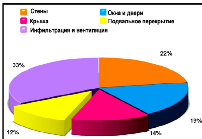
Рис. 1. Баланс потерь тепловой энергии в здании до проведения комплексной термомодернизации
