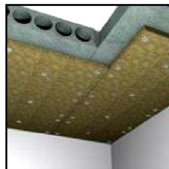
Рис. 6. Пример утепления подвального перекрытия со стороны подвала
