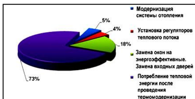
Рис.1. Баланс распределения тепловой энергии в зданиях после проведения частичной термомодернизации
